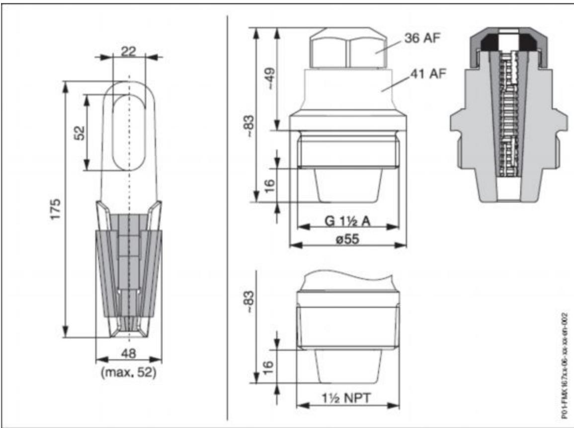
**Габариты клеммной коробки IP 66/IP 67 с фильтром**
