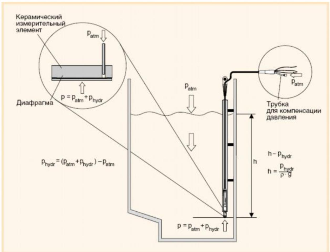
Условные обозначения:  $h$  — высота уровня жидкости;  $p$  — общее давление (гидростатическое + атмосферное);  $\rho$  — плотность измеряемой среды;  $g$  — ускорение свободного падения;  $p_{hydr}$  — гидростатическое давление;  $p_{atm}$  — атмосферное давление.
