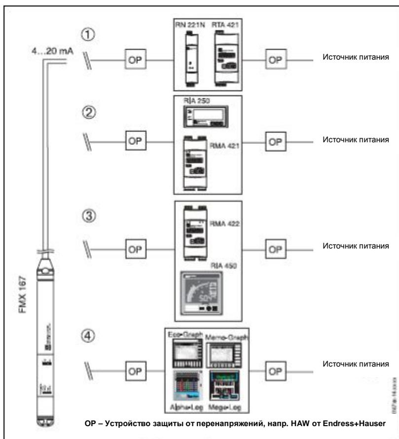
1. Простое, эффективное по затратам решение для проведения измерений RN 221N: Источник питания для Waterpilot - RN 221N для использования в опасных и неопасных зонах. Источник питания и дополнительный контроль двух потребителей питания, напр., насосы, посредством концевого переключателя RTA 421 с отображением на дисплее на месте проведения измерений.
