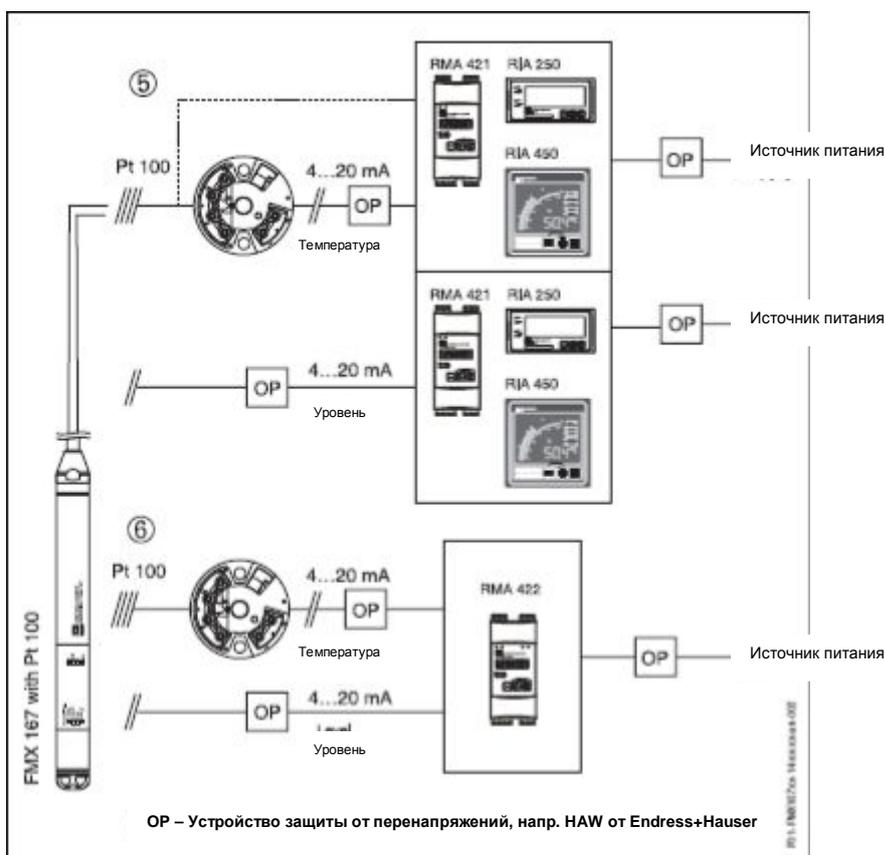
5. Если вам нужно измерять, видеть процесс на дисплее и оценивать температуру, а также уровень, напр., следить за температурой свежей воды для определения предельного значения температуры, при которой начинается размножение микроорганизмов, у вас есть следующие опции:
