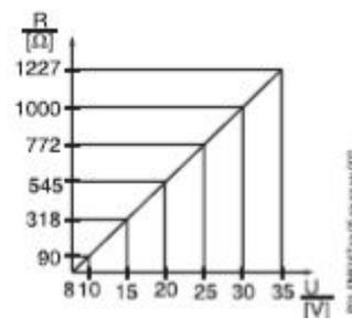
Диаграмма нагрузки датчика температуры для оценки сопротивления нагрузки. Вычтеть значение дополнительного сопротивления из вычисленного значения, согласно показанному в формуле!
